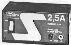
Alimentatore stabilizzato "FALKOS" Con protezione elettronica. Tensione di ingresso: 220 V - 50 Hz Tensione d'uscita: 12,6 V.c.c. Corrente d'uscita: 2,5 A Dimensioni: 160 x 75 x 115 NT/0060-00
