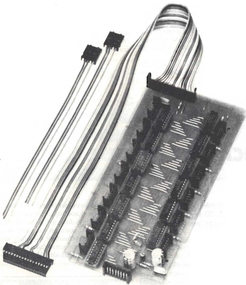
Fig. 10. Modulo contenente 13 TDA1008; esso contiene i divisori di frequenza e gli interruttori di passaggio delle note corrispondenti a cinque ottave.
