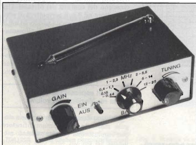
Fig. 1. Aspetto esterno del preamplificatore montato e racchiuso in un mobiletto.
